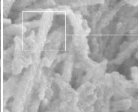
Calciumfluorid-ähnliche Partikel dicht an dicht nach der Applikation von Fluor Protector S, rasterelektronenmikroskopische Aufnahmen, Vergrößerung: 30'000 x (Ivoclar Vivadent, F&E 2012)
